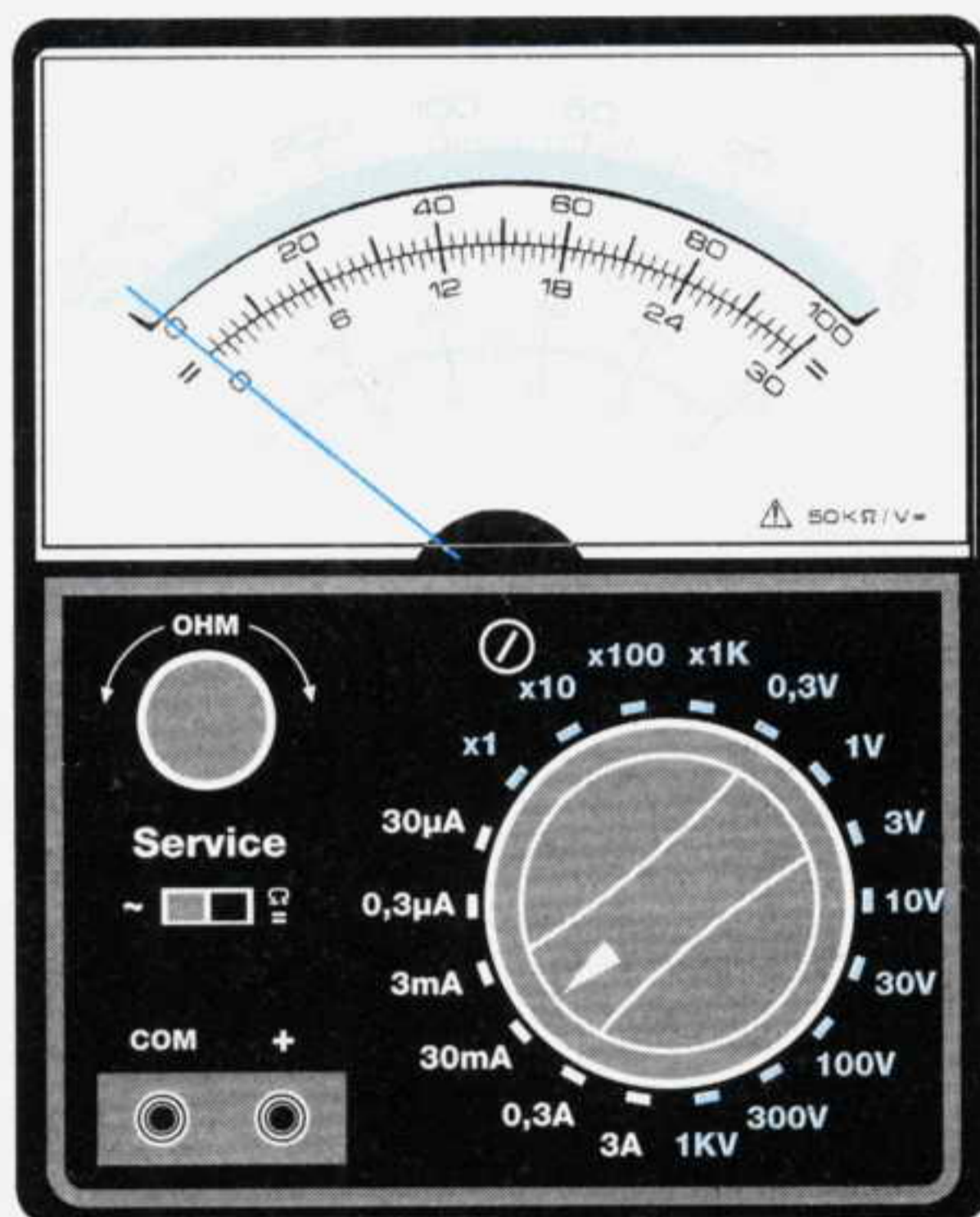
Fig.374 Nella funzione Amperometro CC, ruotando la manopola sulle portate contrassegnate 30-0,3 \mu A o sulle portate 3-30 mA - 0,3-3 A. il valore andrà letto sulla scala graduata da 0 a 30. Per la portata 0,3 A. il valore andrà diviso per 100, mentre per la portata 3 A. andrà diviso per 10.
