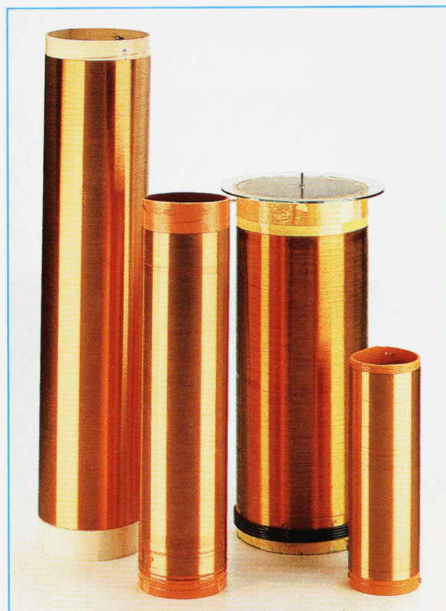
Fig.2 Se volete autocostruirvi un trasformatore di Tesla, dovrete avvolgere su un tubo PVC più di 1.000 spire in modo da ottenere una frequenza di accordo che non risulti mai superiore a 240.000 Hertz.
