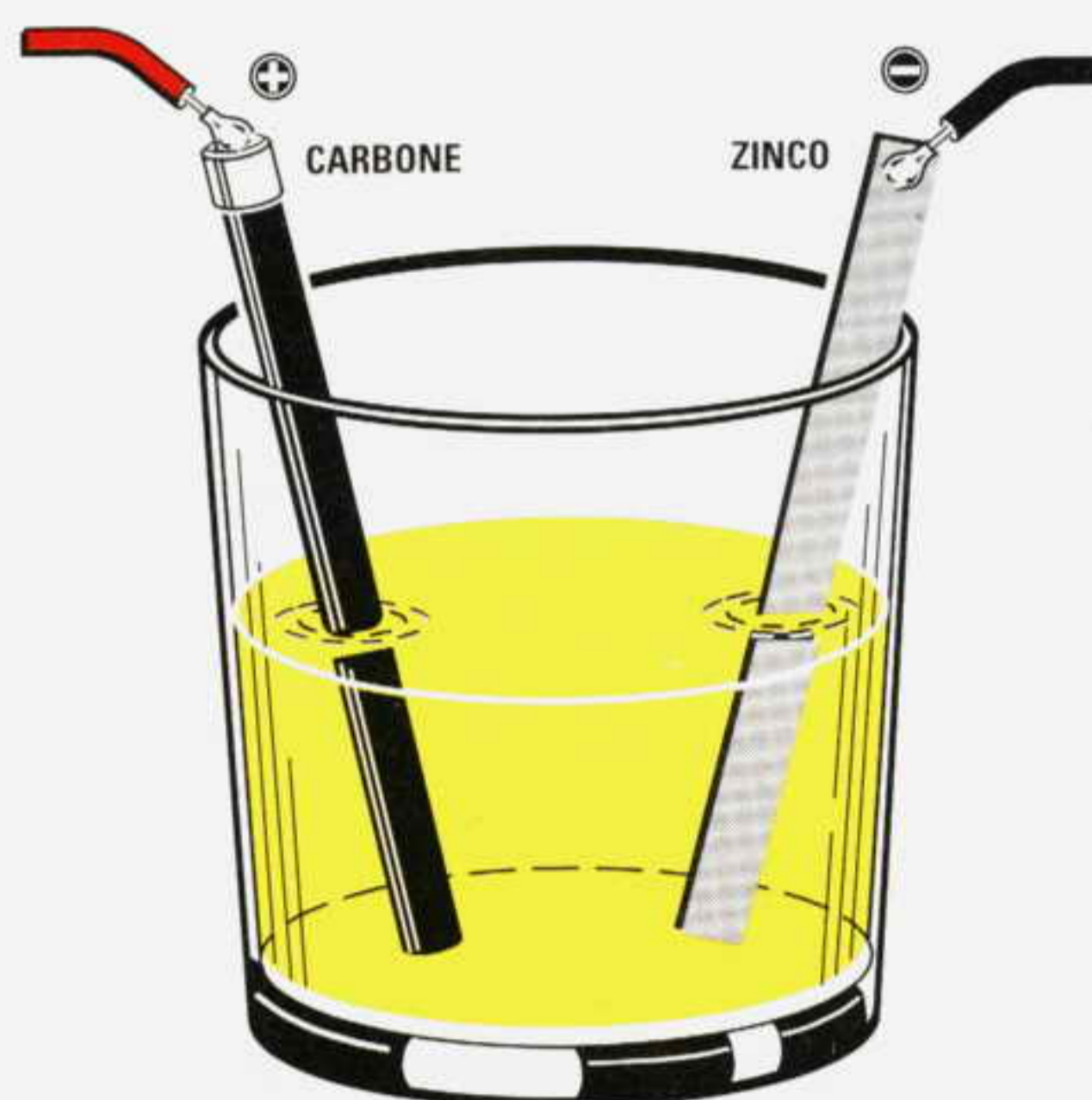
Fig.386 Inserendo un ritaglio di rame ed uno di zinco in un piccolo bicchiere e versando al suo interno del succo di limone otterrete da ogni pila una tensione di circa 0,93 volt. In sostituzione del ritaglio di rame si potrà utilizzare la barretta cilindrica di carbone presente all'interno di una pila da 1,5 volt oppure da 4,5 volt.
