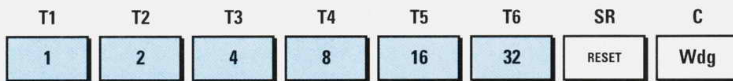
Fig.1 Il Watchdog utilizza come contatore i soli 6 bits indicati T1-T2-T3-T4-T5-T6. Come visibile nel disegno, il bit T1 vale 1 e il bit T6 vale 32, quindi sommando tutti questi "pesi" otteniamo 63 e sommando a questi il ciclo 0 otteniamo un totale di 64.
